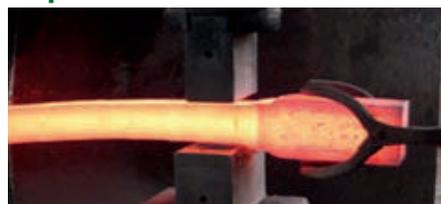
Pode ser de dois tipos: por prensagem ou martelamento. Nos dois casos, o maquinário incube uma força vertical de compressão na peça aquecida para que ela tome uma nova forma. A diferença, contudo, é que a prensagem tem a força contínua, enquanto no martelamento, a força é aplicada rapidamente em intervalos. Enquanto com o martelamento, a peça ganha uma dureza extra na superfície, o que pode ser interessante ou indesejável.
